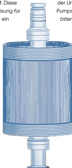
3D-Ansicht des Rotors von Limberg 3
