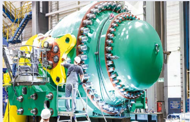
Drucktest und Werksabnahmeprüfung des ersten von sechs Kugelschiebern im Beisein des Kunden im Herbst 2022
