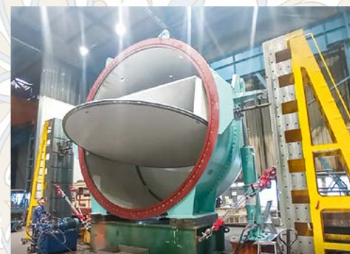
Druckrohrleitungsabsperklappe während der Werksabnahmeprüfung in der ANDRITZ-Werkstatt in Ungarn
