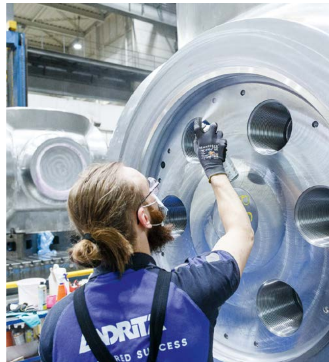
バルブロータのシール面のクラック検査
