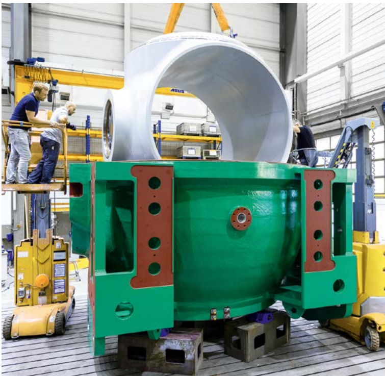
バルブロータの主入口弁ハウジングへの組み付け
