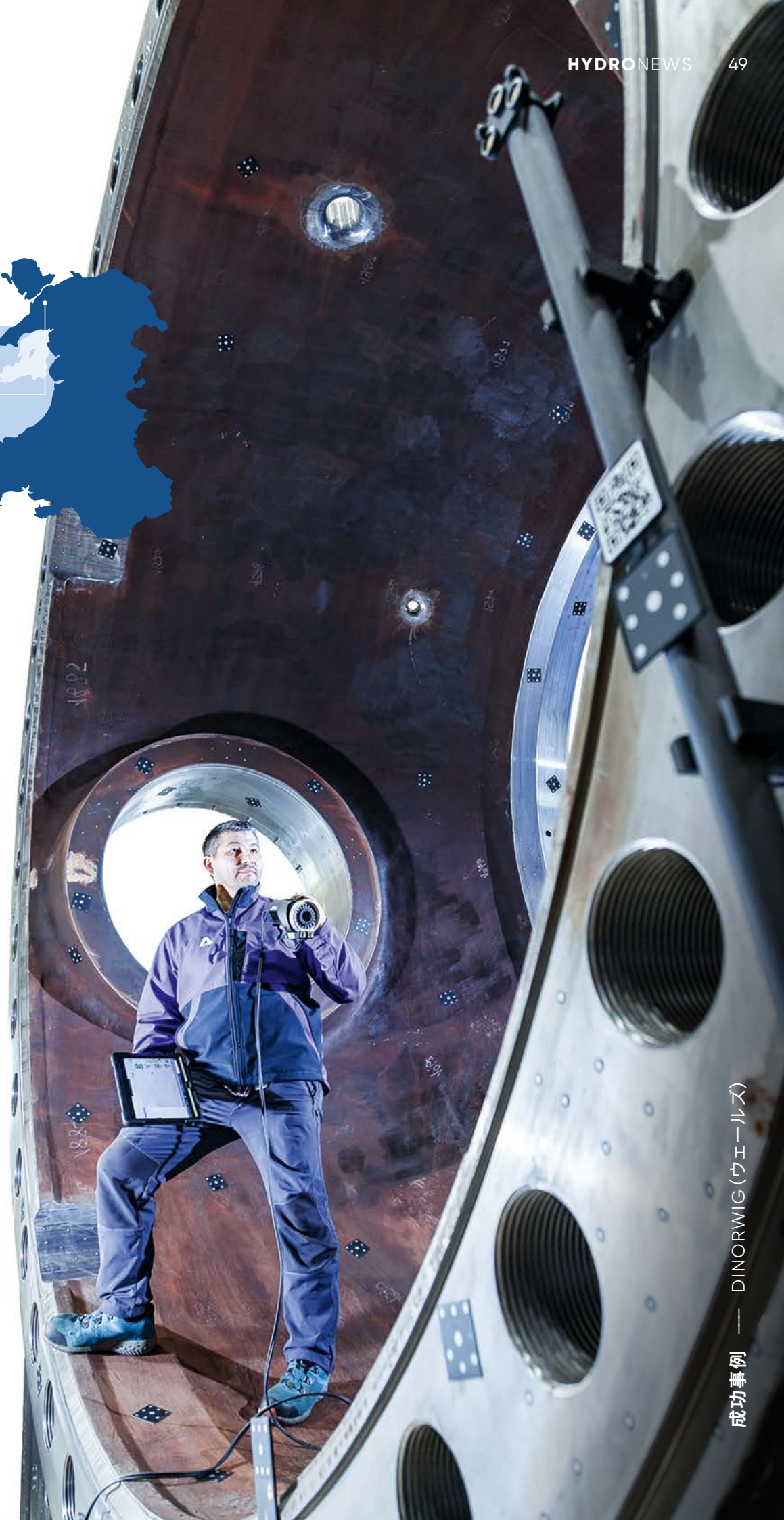
機械加工された球形弁 本体の写真測量測定
