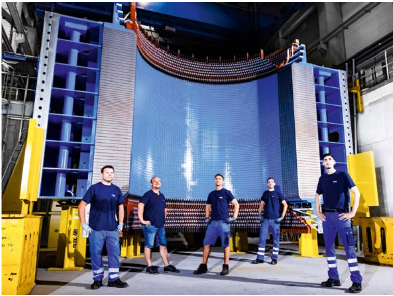
ANDRITZの発電機チームは、顧客との緊密な協力により、2021年にユニットB09の空冷発電電動機を設置しました。
