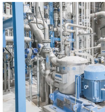
Система подготовки массы состоит из двух линий. Одна предназначена для товарных кип LBKP, другая – для производимой на комбинате суспензии из бамбуковой целлюлозы.
