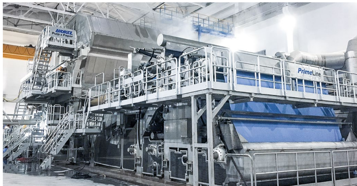
ANDRITZ поставила две одинаковые БДМ PrimeLineST для производства санитарно-гигиенической бумаги, каждая из которых имеет расчетную скорость 2000 м/мин и ширину 5,6 м.
