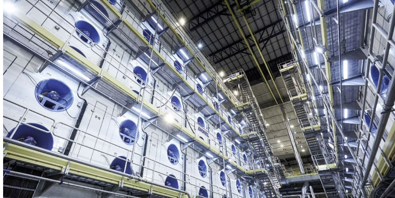
Сушильная установка рассчитана на удельную производительность более 390 тонн в день и метр рабочей ширины. Это успешно апробировано на сушильных установках ANDRITZ по всему миру.
