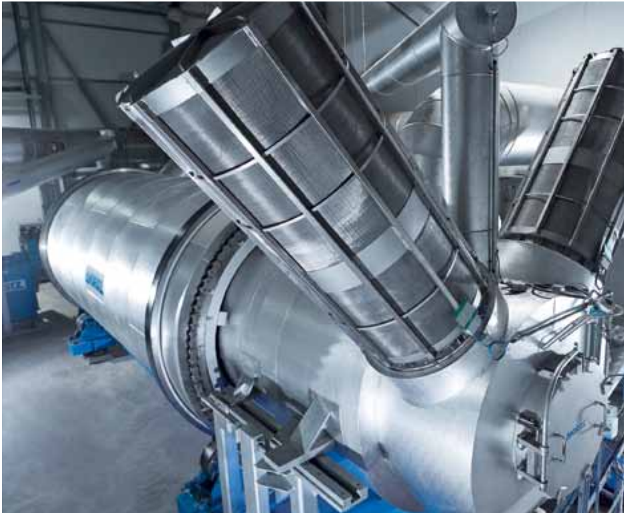
Pilotanlage zur Torrefizierung von Biomasse: Verbesserung der Brennstoffeigenschaften von Biomasse und Reduktion von CO 2 .
